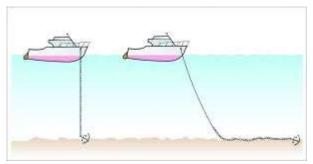
ANCORAGGIO CORRETTO - Le norme prevedono che la lunghezza della cima vada da 3 a 5 volte la profondità del fondale, condizione necessaria per una miglior presa dell'ancora.
